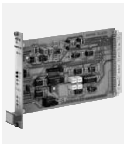
Composants Reglus de haute valeur sur cartes enfichables Euro: la base de systèmes de mesure personnalisés.
