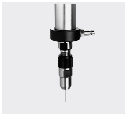
Reglus Elektrodenhalter mit \varnothing 20 mm Schaft, mit drehbarem Spülmittelanschluss (Typ 350.20 E) oder mit internem Spülmittelkanal, Spülung durch die Spindel (Typ 350.20 I).
