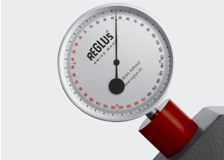
Reglus Winkelmessung: geeignet für Winkelmessungen über \pm 180 Grad (Messgenauigkeit besser als \pm 1/2 Grad, Ablesegenauigkeit 1/4 Grad) in Bezug zur Senkrechten oder Horizontalen.
